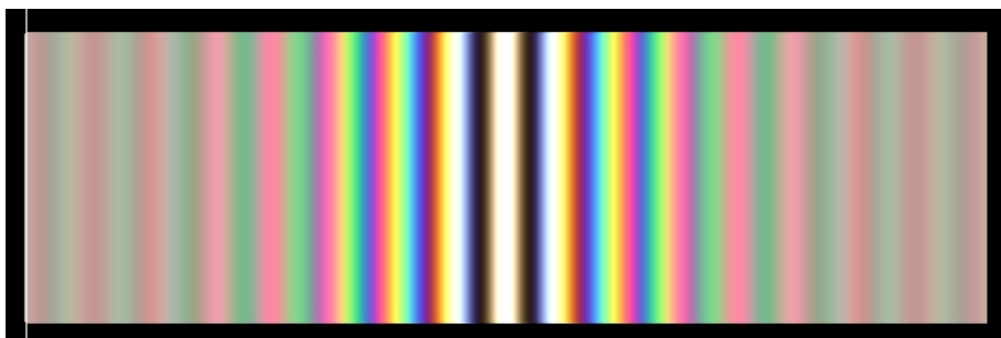
Slika 8. Obarvane interferenčne proge pri Youngovem poskusu z belo svetlobo.
